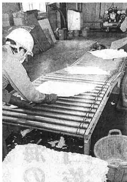
紙おむつのパルプをシート状に加工する工程＝福岡県大牟田市
